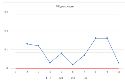
Рисунок 2. Контрольные карты Шухарта для скользящего размаха (MR) для температуры в реакторе на стадии получения извлечения (1 серия, t=20 C)
