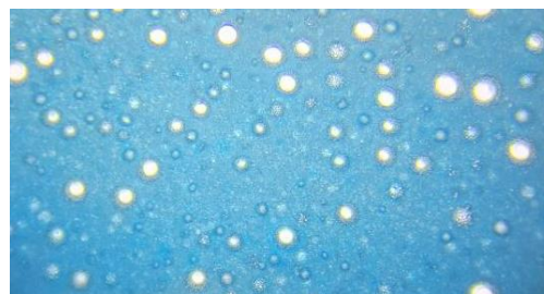
Рис. Вид на микроскопе эмульсии экстракта ромашки аптечной на масле горького миндаля (окрашенного с метиленовым синим): ПАВ - NaСДЖК при концентрации 6% (увеличение в 120 раз)
