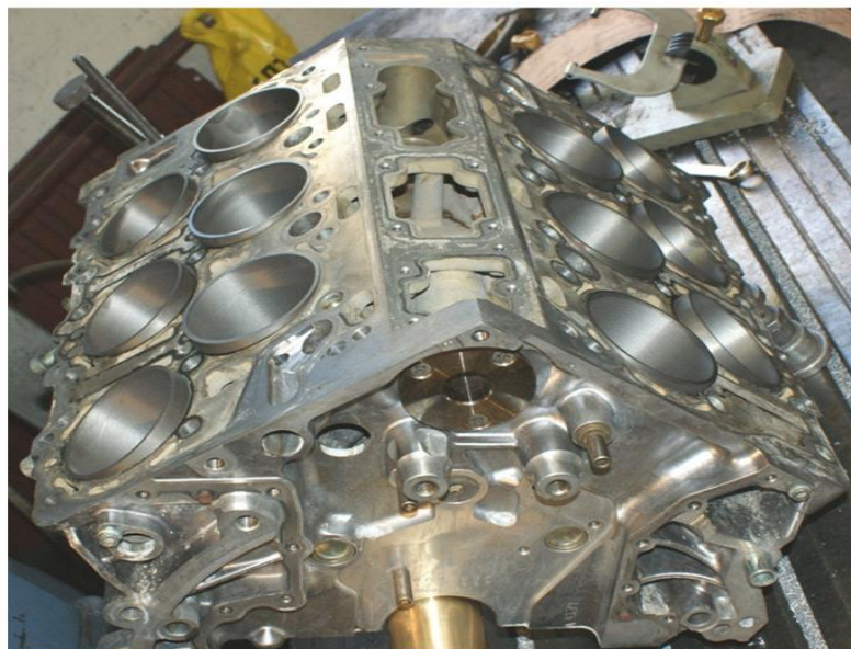
Рис. 4. Гильзовка алюсилового блока чугунными гильзами
