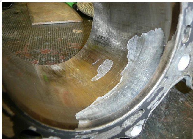
Рис. 3. Разрушение никасилового покрытия цилиндра
