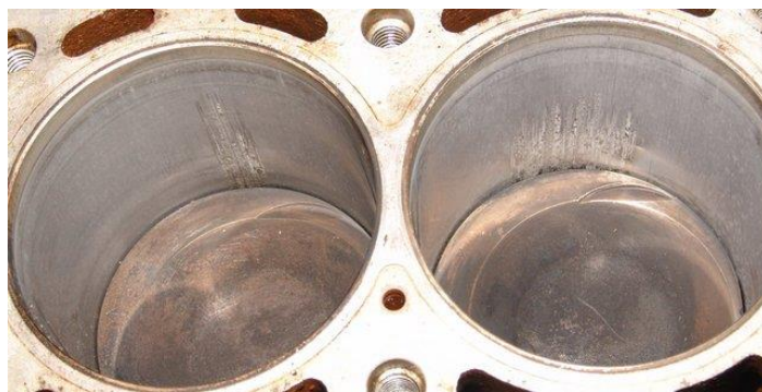
Рис. 1. Износ цилиндров блока ДВС
