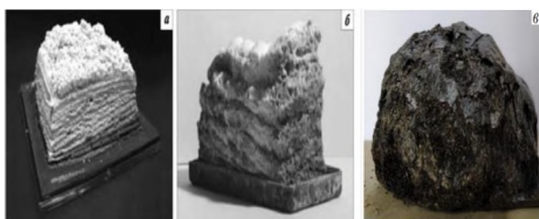
Рис. 2. Вид пенококкса, образующегося под воздействием пламени на металлической поверхности, защищенной слоем (начальная толщина ~0,4 мм, толщина пены ~6-8 см) огнезащитной краски: а – фирмы “Clariant” (аналог) [3]; б – авторы “KHNA” (аналог) [16]; в – в данной работе.
