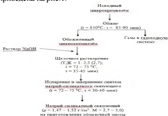
Рис. 1. Рекомендуемая технологическая схема безавтоклавной технологии производства натрий-силикатного связующего на основе микрокремнезём
