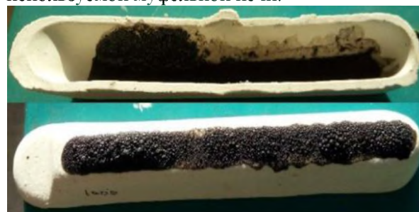
Рис. 2. Исходное состояние образцов микрокремнезема
