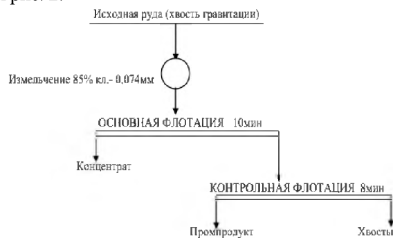
Рис.1. Технологическая схема флотационного обогащения хвостов гравитации Чинарсайской руды
