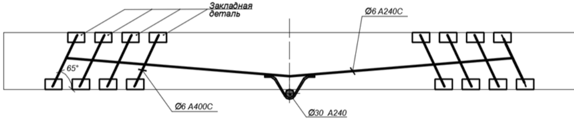
Рис. 1. Схема підсилення балки БПП-II-1 поздовжньо-поперечною зовнішньою системою арматурних стрижнів.
