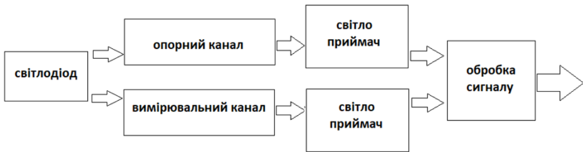
Рисунок 1. 2 - Оптична система детектора
