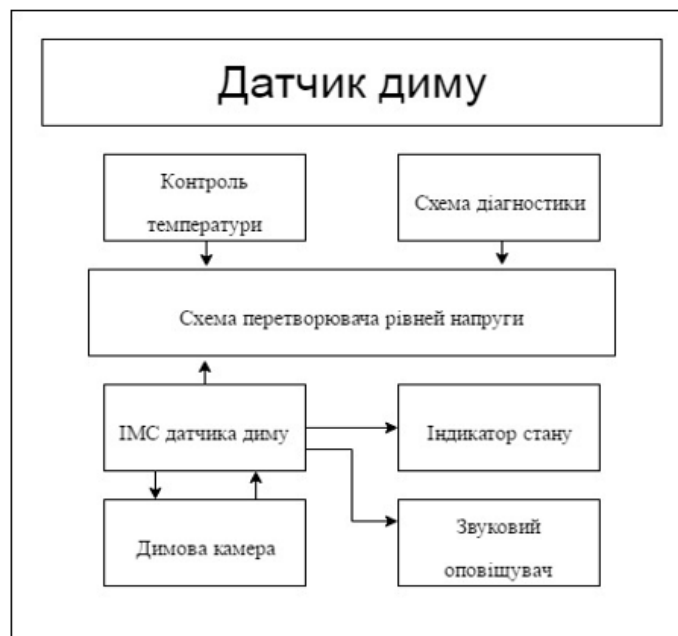
Рисунок 1.1- Загальна блок схема датчика диму
