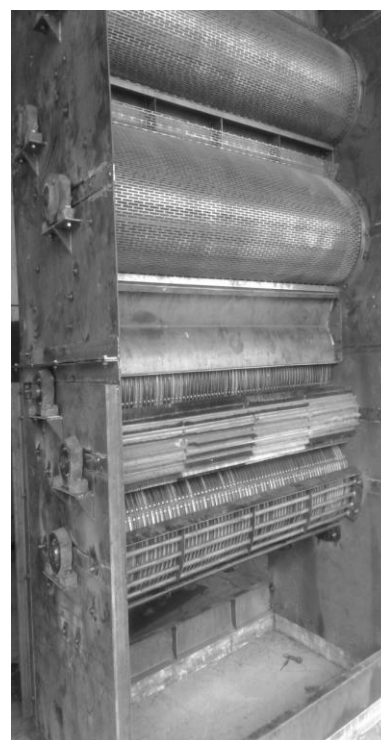
1 – питатель; 2 – секция очистки хлопка от мелкого сора; 3 – колковый барабан; 4 – сетчатая поверхность; 5 – козырек для сора; 6 – сорный шнек; 7 – притирочная щётка; 8 – пильчатый барабан; 9 – колосниковая решетка; 10 – регенерационный барабан; 11 – сорный шнек; 12 – щеточный барабан; 13 – секция очистки хлопка от мелких сорных примесей; 14 – выгрузочная шахта.
