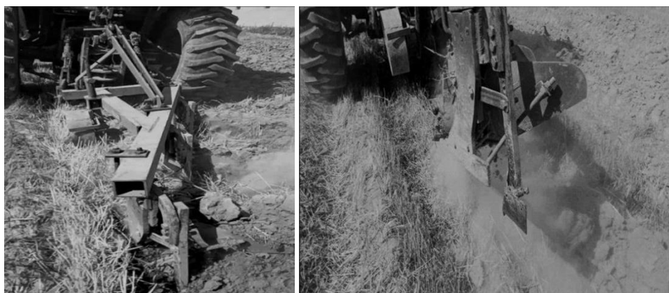
Рисунок 7. Процесс первоначальных полевых испытаний усовершенствованного плуга для углубления грунта
