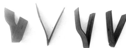
Рисунок 4. Различные варианты лезвия-смягчителя в виде вертикального клина
