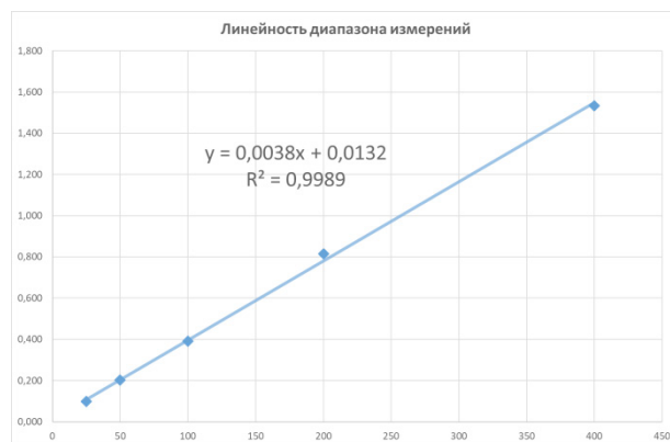
Рис. 2. График линейности методики в изучаемом диапазоне концентраций.
