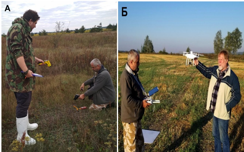
Рис.6. Полеві завіркові роботи. А - Наземні темплетричні дослідження. Б - Запуск БПЛА з тепловізійною камерою.
