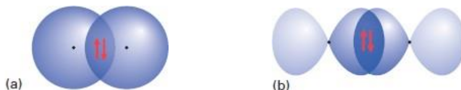
Рис. 1.4.1. Схема перекрывания атомных электронных облаков в молекуле водорода (а) и молекулы хлора (б).
