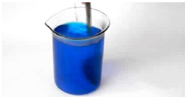
Рис. 3.1.27. Растворение купороса меди в горячей воде.
