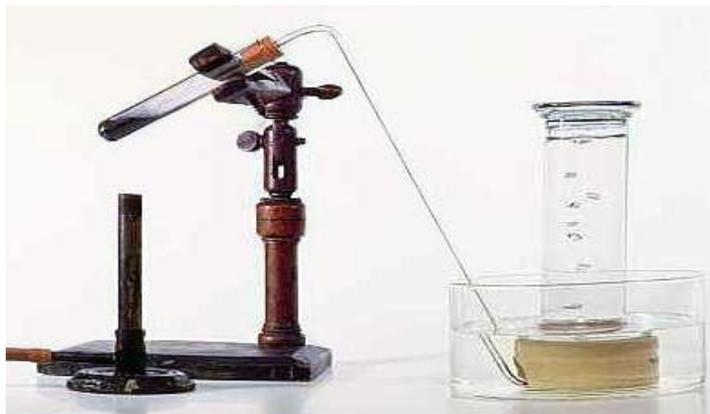
рис. 4.4. Прибор для получения кислорода.
