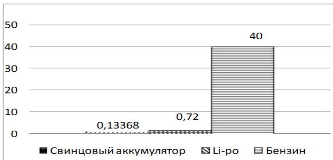
Рисунок 1. Примерная плотность энергии в химических источниках тока и углеводородном топливе
