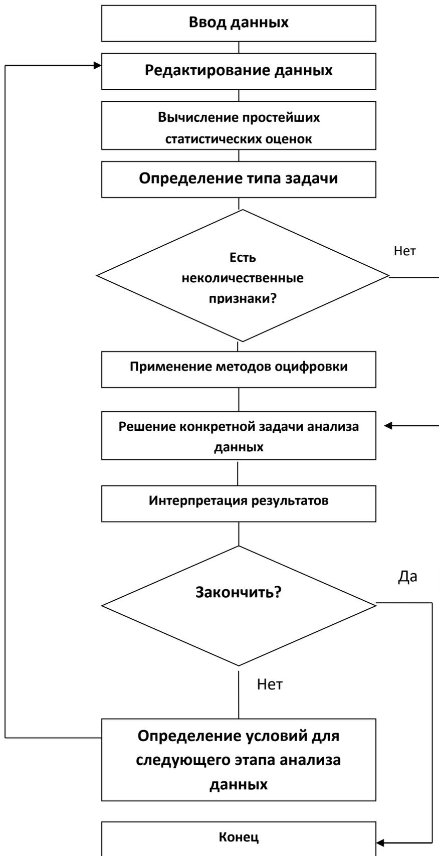
Рис.3.2. Структурная схема анализа данных в системе САД.
