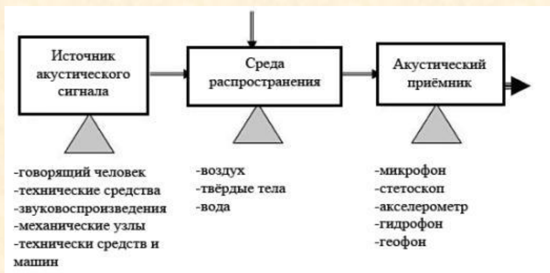
Рисунок – 1. Структура акустического канала утечки информации
