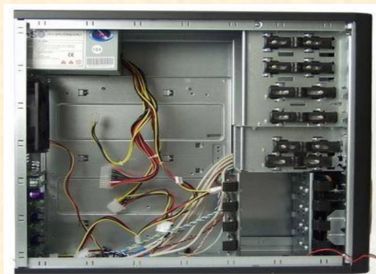
5-rasm. Kompyuterning qismlarga ajratilgan tizim blokining unga elektr ta'minoti o'rnatilgan umumiy ko'rinishi.
