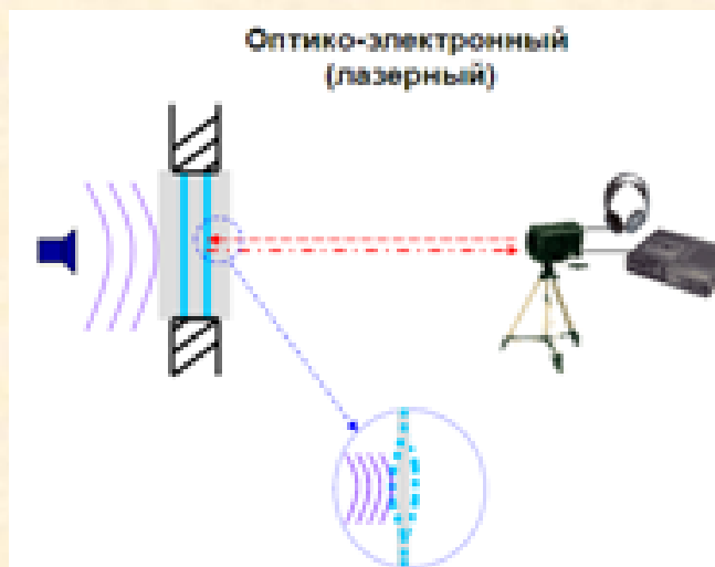
Рисунок–2. Оптико-электронный (лазерный) канал утечки акустической информации
