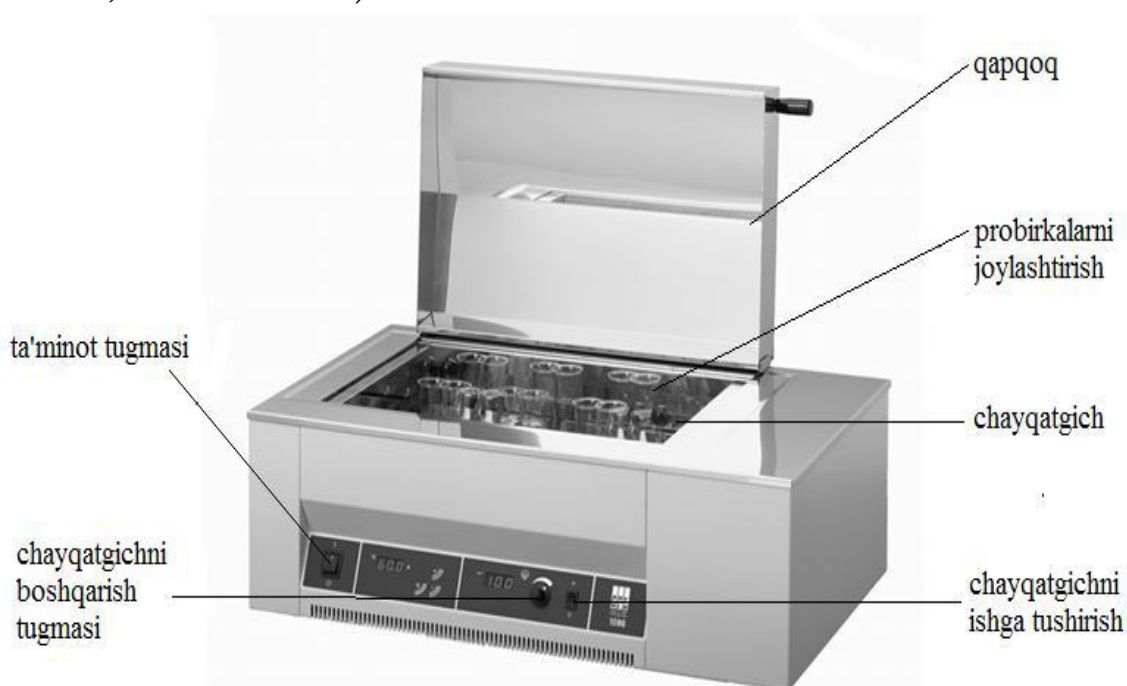
13-rasm. 1086 rusumli chayqatgichli suv hammomining boshqarish elementlari
