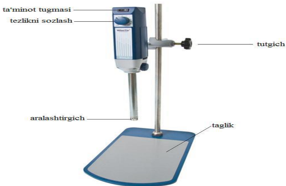
9-rasm. HG-15A gomogenizatorining boshqarish elementlari
