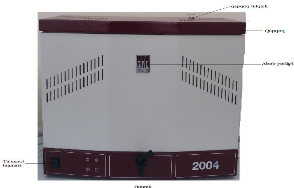
11-rasm. GFL-2004 bidistillyatorlarining boshqarish elementlari
