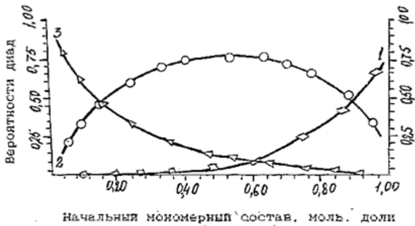
рис. 1.2.3 Зависимость образования различных диад в сополимере ДМАЭМА-Сти с ВП от начального мономерного состава: 1 - m_1 - m_1 ; 2 - m_1 - m_2 - m_2 - m_1 ; 3 - m_2 - m_2 мономерные звенья
