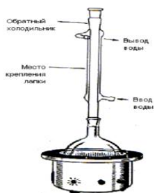
Рис. 2.5. Прибор для нагревания реакционной смеси с обратным холодильником с помощью колбонагревателя.
