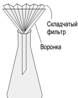
Рис. 3.3. Фильтрация горячего раствора через складчатый бумажный фильтр
