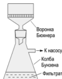
Рис. 3.4. Прибор для фильтрования кристаллов
