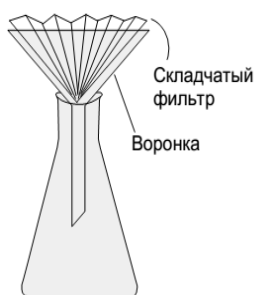
Рис. 3.3. Фильтрация горячего раствора через складчатый бумажный фильтр
